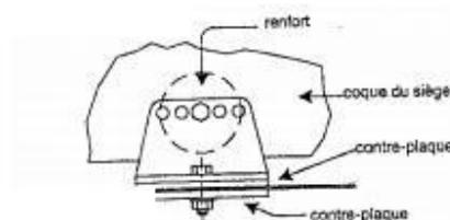
Le siège baquet, est **obligatoire dans tous les groupes**, adopte des rebords de maintien au niveau des cuisses et du buste. Il évite ainsi au pilote de s'agripper au volant au gré des virages et accroît la précision d'inscription en virage en évitant aux mouvements latéraux du corps de contrarier la trajectoire.
