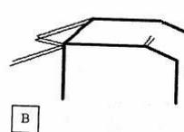
Les cadres ou couples des **arceaux (principal)** doivent être réalisés en une seule pièce sans connexion. Leur construction doit être uniforme et dépourvue d'ondulations ou de fissures. La partie verticale de l'arceau principal doit être aussi droite et aussi près du contour intérieur de la coque que possible. Le montant avant d'un arceau avant ou latéral doit être droit ou ne comporter qu'un seul coude autant que possible.
