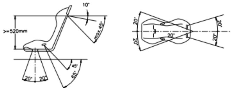
Les sangles d'épaules doivent être dirigées en arrière vers le bas et ne doivent pas être montées de façon à créer un angle de plus de 45° par rapport à l'horizontale, à partir du bord supérieur du dossier, et il est conseillé de ne pas dépasser 10°
