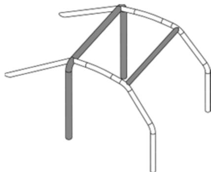
La partie verticale de l'arceau principal doit être aussi près du contour intérieur de la coque que possible et ne comporter qu'un seul coude avec sa partie verticale inférieure.
