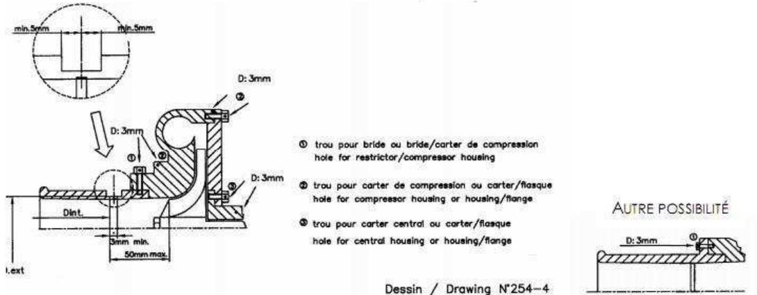
Le montage de la bride sur le turbo doit être effectué de telle façon qu'il soit nécessaire de retirer entièrement deux vis du corps du compresseur, ou de la bride, pour pouvoir désolidariser la bride de compresseur. Le montage par vis pointeau n'est pas autorisé.
